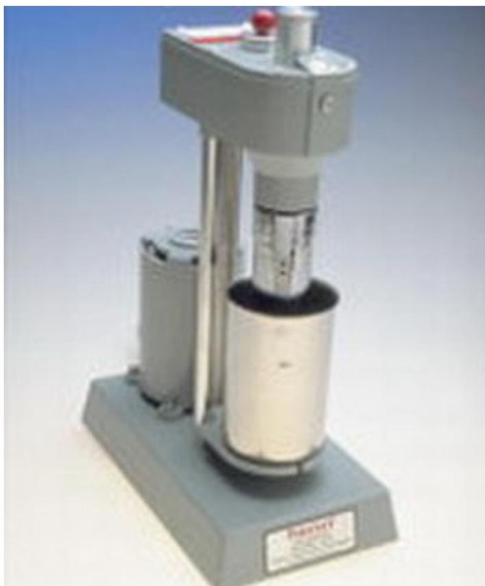
Вискозиметр FANN® модель 35 – устройство прямого считывания с шестью скоростями типами для использования с питанием 60 Гц. Стандартный источник питания 115 Вольт, но модель может быть оснащена трансформатором, который делает возможным использование с питанием 220/230 вольт.
