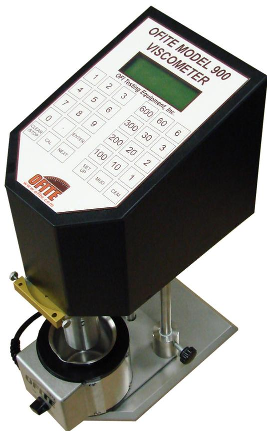
Вискозиметр представляет собой портативный и полностью автоматизированный прибор, предназначенный для определения реологических свойств буровых и тампонажных растворов, а также жидкостей ГРП.
