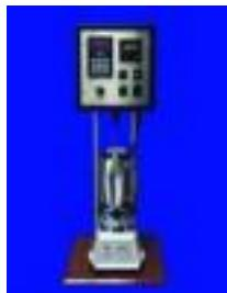
Мешалка постоянной скорости OFITE - предназначена для приготовления цементного раствора для проведения испытаний в строгом соответствии с технологией, утвержденной API, Спецификация 10. Исследования показали, что характеристики тампонажных цементов напрямую зависят от процесса перемешивания. Применение мешалки с постоянной скоростью OFITE при исследованиях времени схватывания тампонажных цементов привело к улучшению воспроизводимости результатов.
