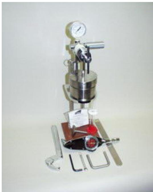
Прибор для испытания на прихват под перепадом давлений (изготовитель – компания OFI) обеспечивает измерение характерного для промывочных жидкостей “коэффициента прихвата бурильных колонн”, а также позволяет определить, насколько могут быть эффективными смазочные присадки и методы обработки в сочетании с той или иной промывочной жидкостью. Указанный коэффициент учитывает трение или “налипание” глинистой коркой, при котором будет происходить застывание или прихватывание труб в скважине.
