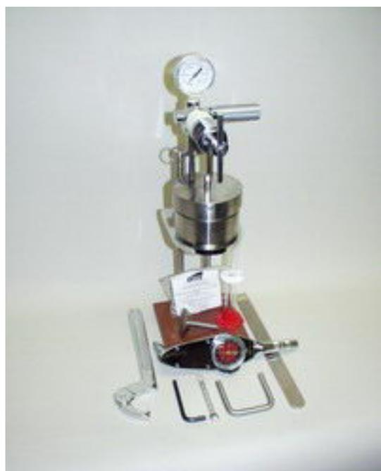
Прибор для испытания на прихват под перепадом давлений (изготовитель – компания OFI) обеспечивает измерение характерного для промысловых жидкостей “коэффициента прихвата бурильных колонн”, а также позволяет определить, насколько могут быть эффективными смазочные присадки и методы обработки в сочетании с той или иной промысловой жидкостью. Указанный коэффициент учитывает трение или “налипание” глинистой коркой, при котором будет происходить застывание или прихватывание труб в скважине.
